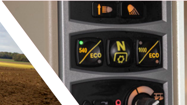
Elektrohydrauliskt manövrerad växling av kraftuttagsvarvtal
