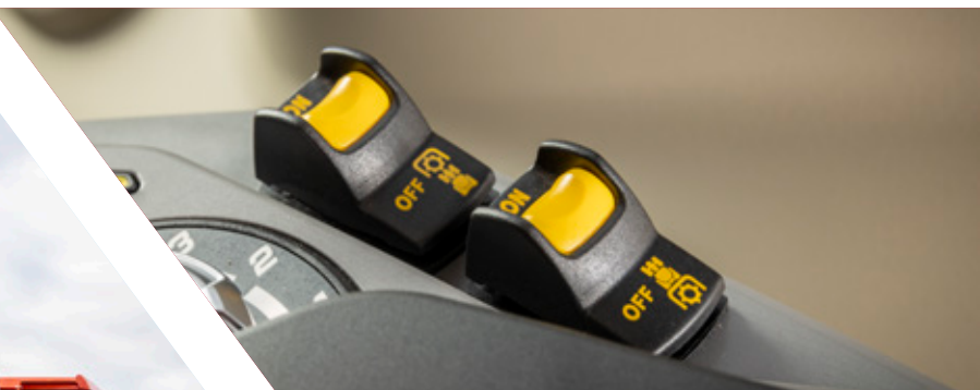
Elektrohydrauliskt manövrerad växling av kraftuttagsvarvtal
