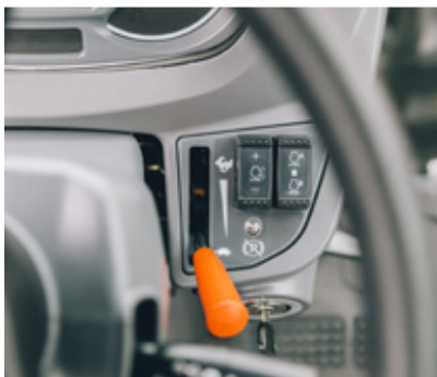
Praktiska reglage för att ställa in och aktivera motorvarvtalet
