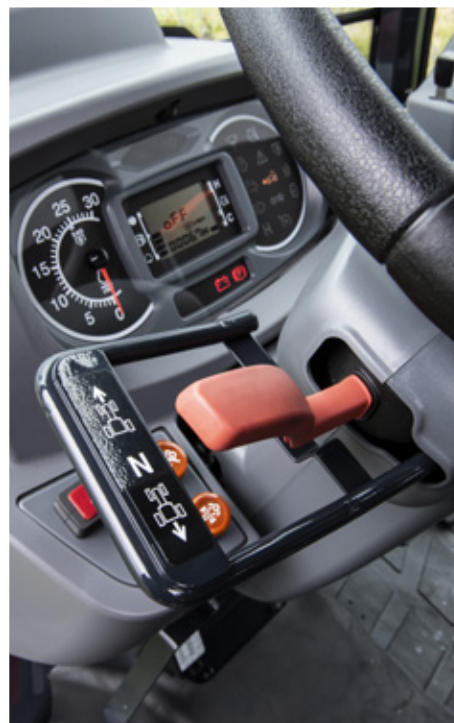
Elektrohydraulisk korrigeringsspak på MF 1700 M-modellerna ökar komforten
