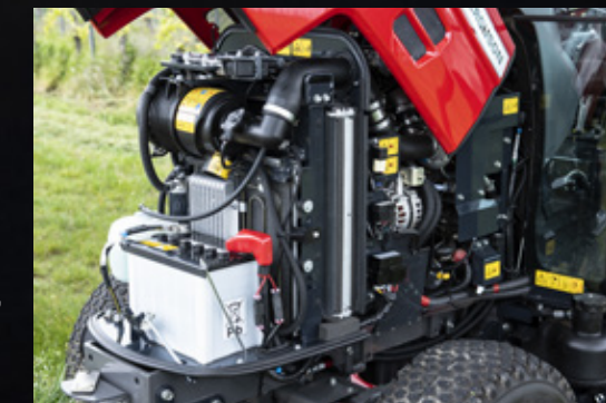
Tack vare smart design på motorhuv och framaxel garanteras bekväm åtkomst till motorn.
