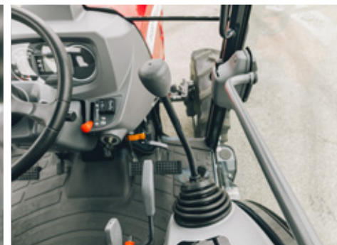
Bättre komfort med den fällbara rattstången och den hydrauliska joysticken på höger sida för enkel och exakt reglering av redskap
