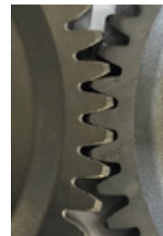
Robust konstruerad rotorbalk för hög kraftöverföring och lång livslängd. Stora kuggdrev med 3,5 tänder alltid i ingrepp
