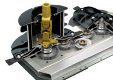
Robust konstruerad rotorbalk för hög kraftöverföring och lång livslängd. Stora kuggdrev med 3,5 tänder alltid i ingrepp
