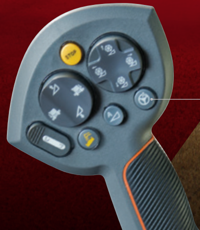
Aktivering av autostyrning
