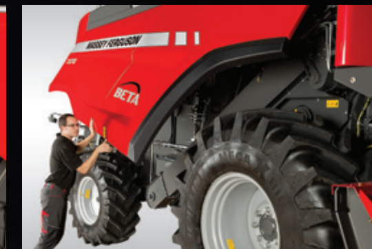
Sidoluckor i ett stycke med belysning gör det lätt att komma åt för inspektion
