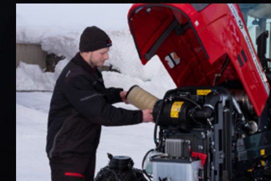
Dobrze skonstruowany układ chłodzenia oferuje łatwy dostęp, łatwe czyszczenie i konserwację. Filtr powietrza silnikowego również jest łatwo dostępny oraz wygodny w czyszczeniu.
