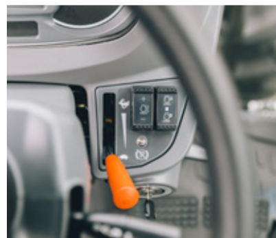
Poręczne elementy sterujące do ustawiania i aktywacji prędkości obrotowej silnika.
