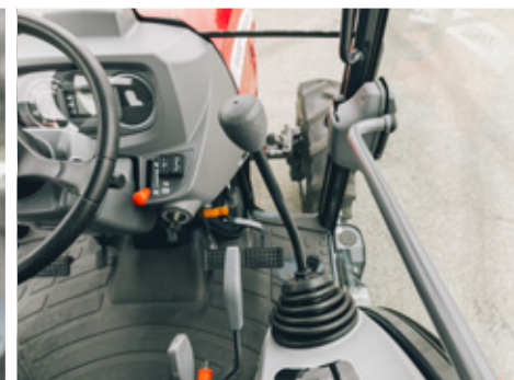
Większy komfort dzięki odchylanej kolumnie kierownicy i prawemu joystickowi hydraulicznemu do łatwego i precyzyjnego sterowania narzędziem.
