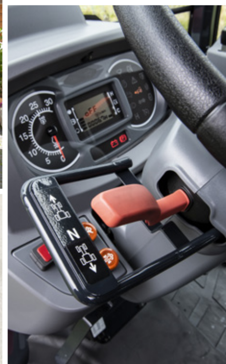
Elektro-hydrauliczna dźwignia zmiany biegów w modelach MF 1700 M poprawiająca komfort pracy.
