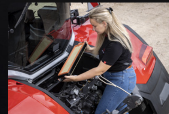
Cabineluchtfilter gemakkelijk bereikbaar om te reinigen
