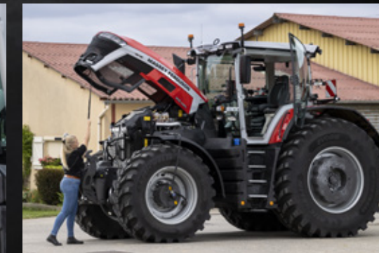
Foraksel og slankt panser gir enkel tilgang til peilepinne og filter.
