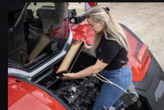
Enkel tilgang for rengjøring av førerhusets luftfilter
