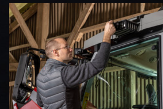
Enkel fjerning av førerhusets luftfilter for rengjøring.
