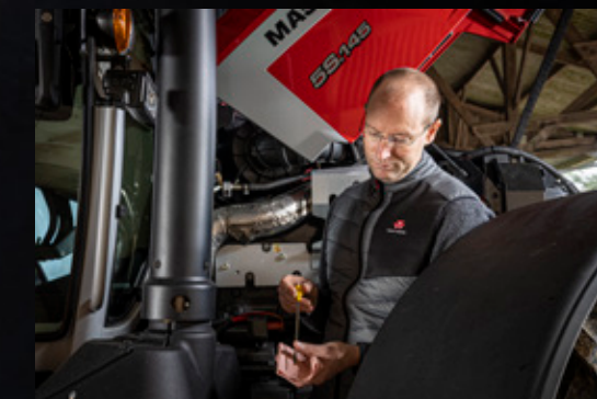
Foraksel og slankt panserdesign gir enkel tilgang til oljepeilepinne og filter.
