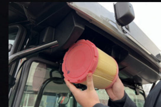
Enkel fjerning av førerhusets luftfilter for rengjøring.
