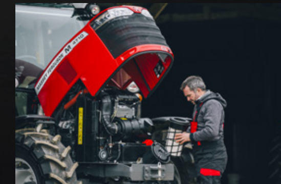
Motorluftfilteret er lett å komme til for rengjøring.
