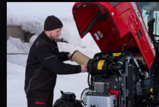
Det er lett tilgang til den velproposjonerte kjølepakken, som er enkel å rengjøre og vedlikeholde. Også motorluftfilteret er lett å komme til for rengjøring.
