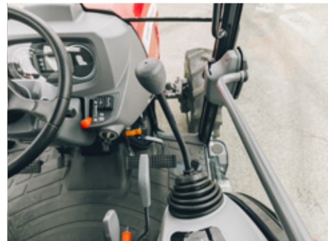
Økt komfort med rattstamme som kan vippes og hydraulikkspak på høyre side for enkel og nøyaktig styring av redskaper
