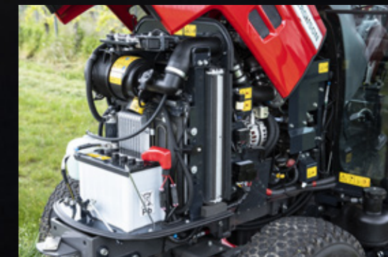
Det innsvingte panseret og konstruksjonen av forakselen gir enkel tilgang til motoren.
