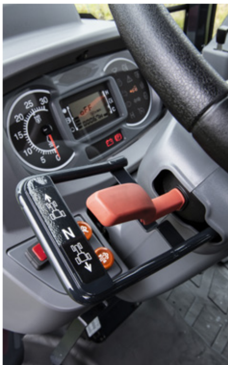
Elektrohydraulisk vendegirspak på MF 1700 M-modellene gir større komfort
