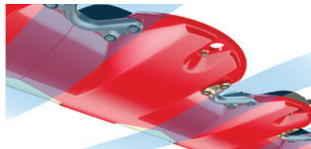
Strømlinjeformet knivbjelke (underside)
