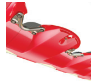
Strømlinjeformet knivbjelke (underside)
