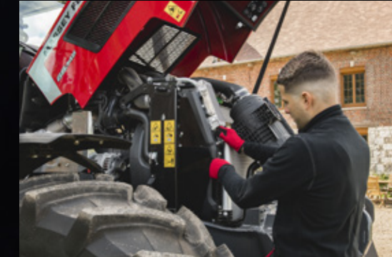
Il pacchetto di raffreddamento è facilmente accessibile per rendere la pulizia più facile e veloce.
