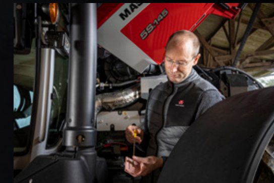
L'assale anteriore e il design affusolato del cofano garantiscono un facile accesso all'astina di livello e ai filtri dell'olio motore.
