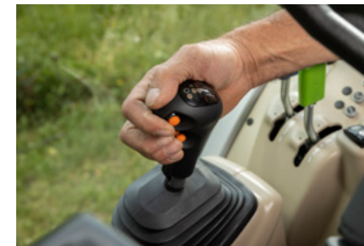
▲ Nuova leva del cambio con cavi Bowden per un funzionamento fluido.
