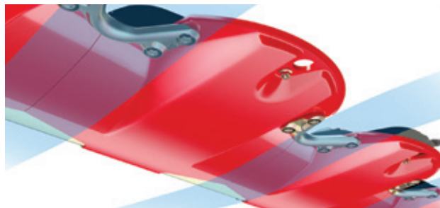
Profilo aerodinamico della barra falciante (lato inferiore)
