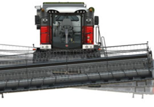
Su richiesta, per la testata è disponibile il comando AutoLevel con controllo dell'altezza di taglio. Grazie all'elevata sensibilità del sistema di interazione tra l'impianto idraulico ed elettronico, il controllo ottimale da un lato all'altro garantisce un'altezza di taglio costante.
