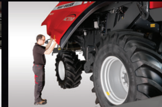
Cofani integrali con luci integrate per velocizzare l'ispezione
