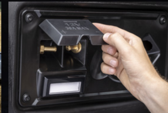
Avec le pack professionnel en option, vous disposez de deux prises électriques de 12 V intégrées au réservoir de carburant pour alimenter une pompe à carburant ou à AdBlue® externe.
