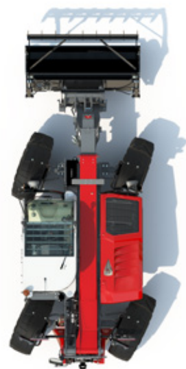
MODE MARCHÉ EN CRABE – pour les travaux le long des murs et dans les espaces confinés.
