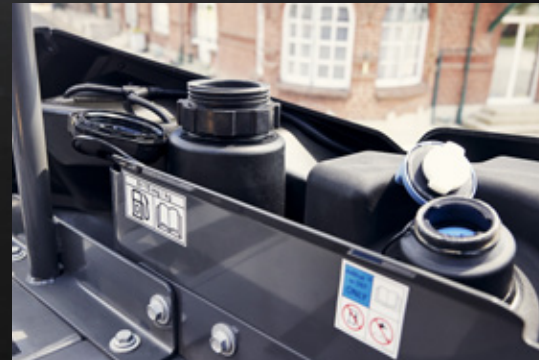
Remplissage facile – les orifices de remplissage de carburant et d'AdBlue se situent côte à côte pour un accès facile
