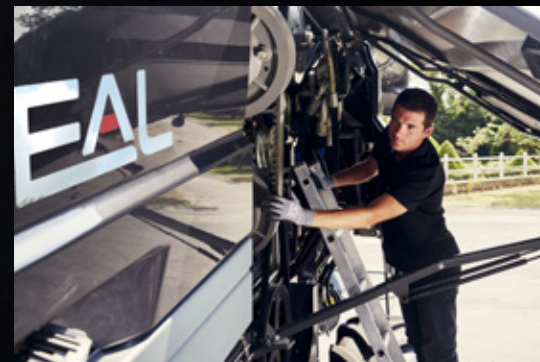
L'échelle arrière amovible facilite l'accès autour de la machine
