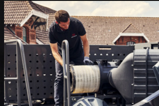
Accès facile pour le contrôle et le nettoyage du filtre à air
