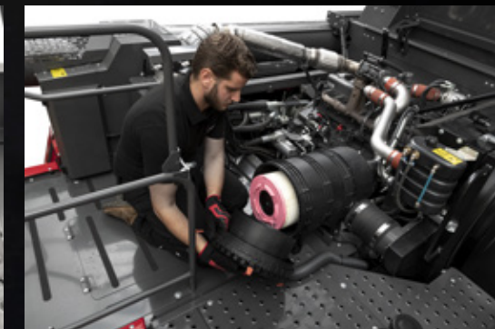
Contrôle et nettoyage du filtre à air
