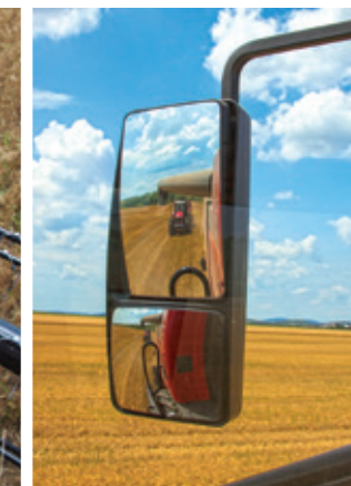
Visibilité multiple à partir des rétroviseurs en deux parties
