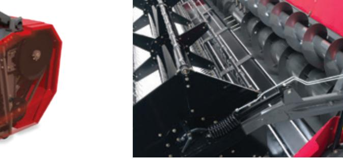
La vis pour colza disponible en option pour la table PowerFlow améliore le flux des récoltes hautes vers le convoyeur et augmente ainsi considérablement le débit de la machine. Deux scies latérales électriques viennent compléter le kit pour colza.
