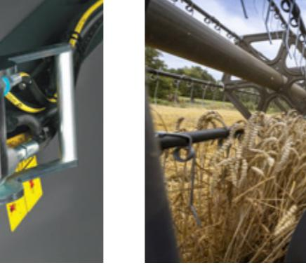
Multicoupleur combinant les branchements hydrauliques et électriques de série pour une dépose de table rapide.
