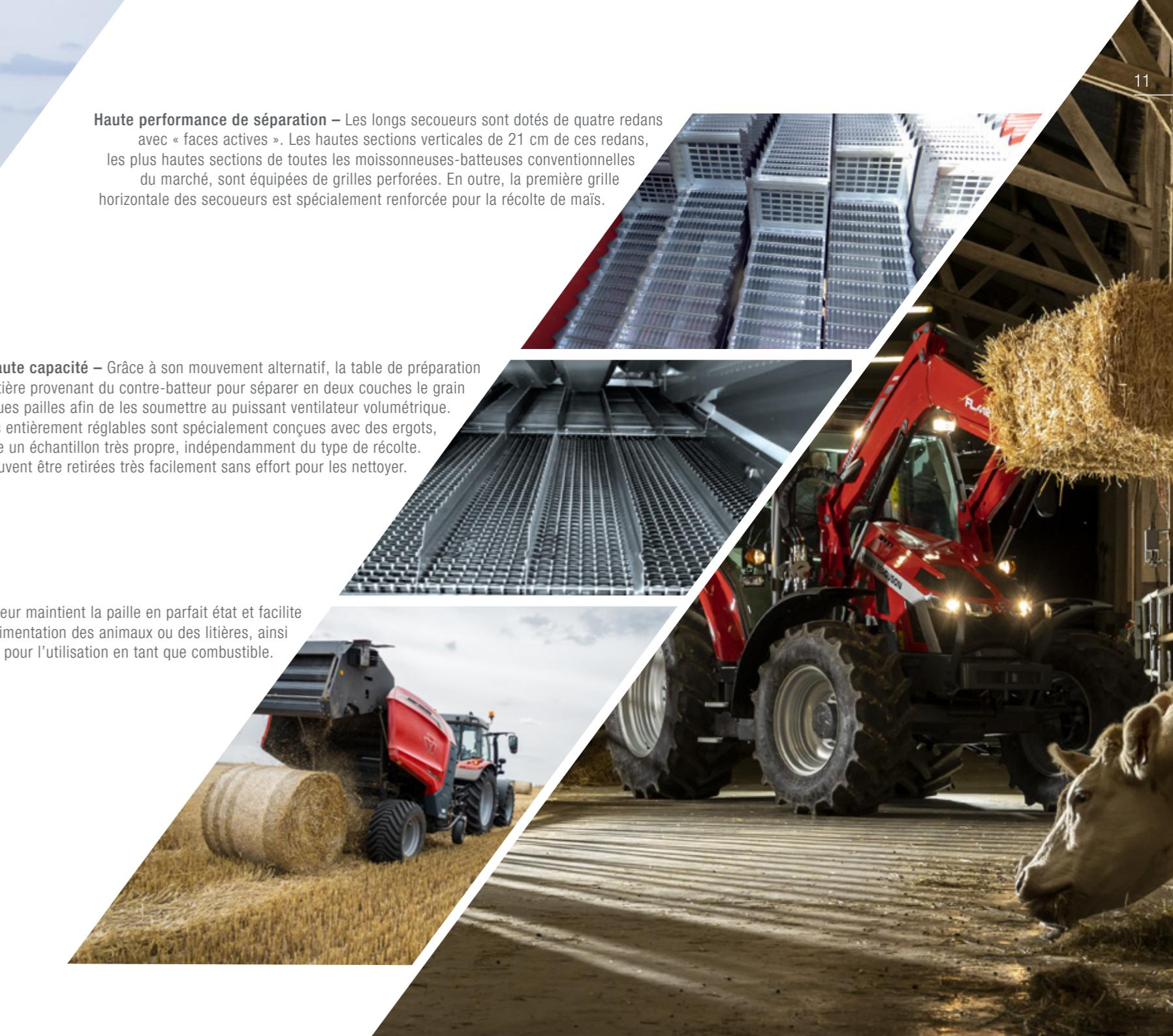
**Haute performance de séparation** – Les longs secoueurs sont dotés de quatre redans avec « faces actives ». Les hautes sections verticales de 21 cm de ces redans, les plus hautes sections de toutes les moissonneuses-batteuses conventionnelles du marché, sont équipées de grilles perforées. En outre, la première grille horizontale des secoueurs est spécialement renforcée pour la récolte de maïs.
