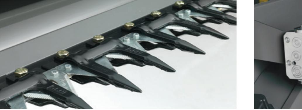
Avec 1 254 coups par minute, le lamier Schumacher est le plus performant du marché. Autonettoyant et constamment aiguisé, il se charge de la coupe de la récolte sans interruption et même dans les conditions les plus difficiles.
