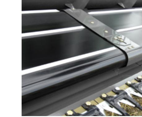
Le lamier se situe à 1,14 m de distance de la vis d'alimentation de la table de coupe afin d'offrir une visibilité et des performances optimales. Les robustes tapis PowerFlow transfèrent la récolte depuis le lamier jusqu'à la vis d'alimentation à vitesse constante, et se chargent également d'éjecter les pierres afin d'éviter tout endommagement de la machine.
