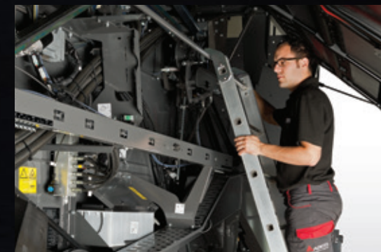
Échelle sur rail pour une inspection facile et sûr
