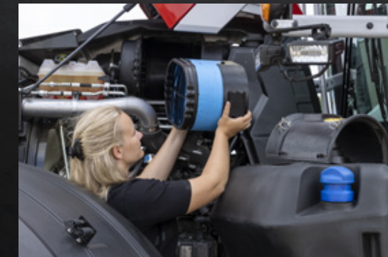
Moottorin ilmansuodattimen vaihtaminen on erittäin helppoa
