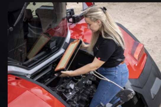
Ohjaamon ilmansuodatin on helposti irrotettavissa puhdistusta varten
