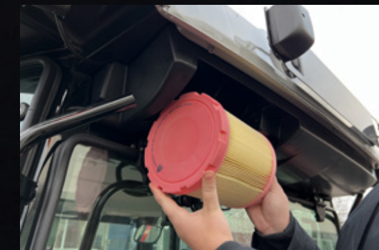
Ohjaamon ilmansuodatin on helposti irrotettavissa puhdistusta varten.
