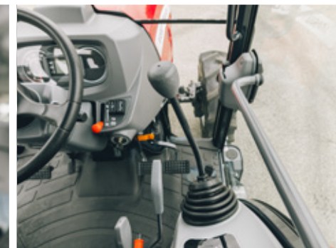
Lisää mukavuutta kallistettavan ohjauspylvään ja oikean käden hydraulisella ohjaussauvalla, jolla työkoneita hallitaan helposti ja tarkasti
