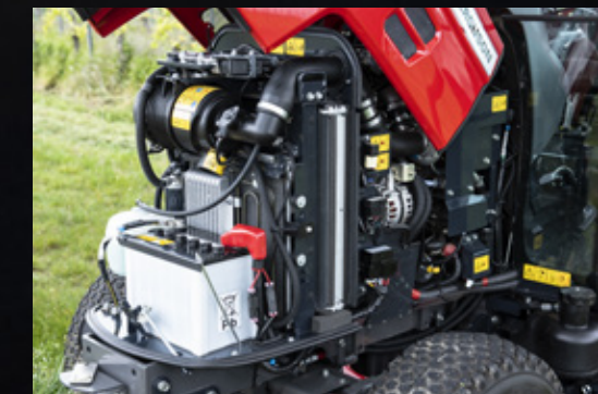
Kapea konepelti ja etuakselin fiksua muotoilu helpottavat moottoriin pääsyä.
