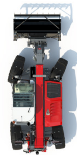
PUOLI-RAPUOHJAUS asetettu takarenkaan kulma – käytännöllinen esimerkiksi rehunkäsittelyssä tai navetan siivouksessa.
