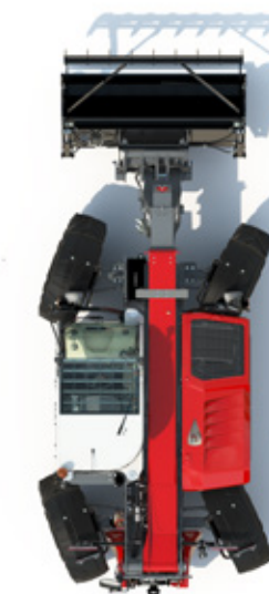
MODO DE DIRECCIÓN a las cuatro ruedas para radios de giro mínimos.
