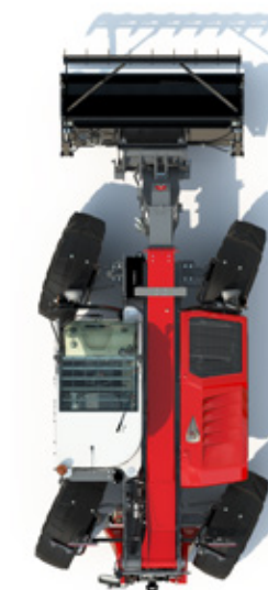
MODO DE MANIOBRA con marcha cangrejo: para un llenado y clasificación eficientes, así como los trabajos junto a paredes en espacios confinados.
