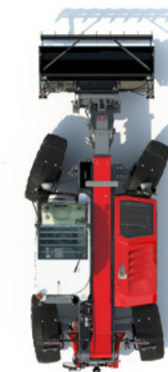
MODO DE MANIOBRA con marcha semicangrejo ajuste del ángulo de la rueda trasera: útil para aplicaciones como ensilado o limpieza del establo.
