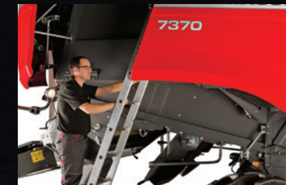
Acceso seguro al compartimento del motor y a la tolva de grano mediante la escalera extraíble
