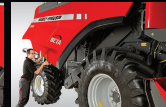
Los paneles de una pieza con luces proporcionan un acceso rápido para inspección
