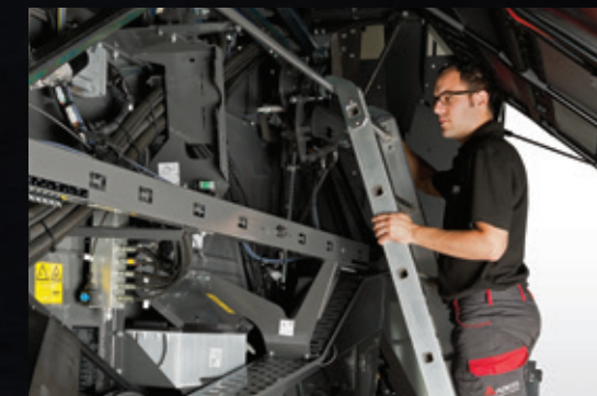
La barandilla de la escalera facilita las inspecciones y aumenta su seguridad
