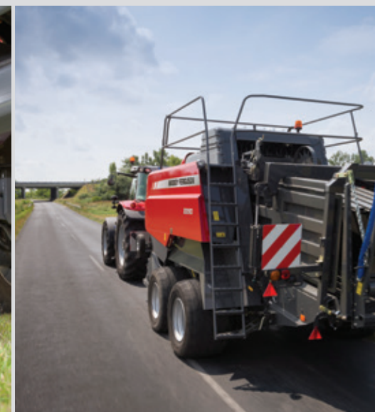
El eje tándem permite alcanzar alta velocidad en carretera y proporciona una gran comodidad de circulación entre campos.
