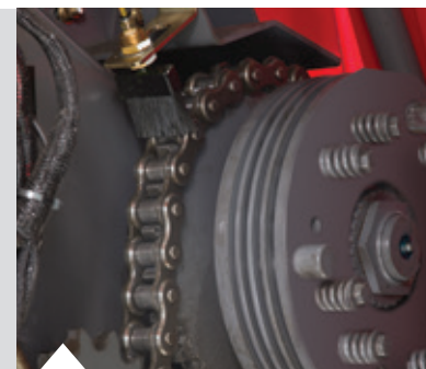
Lubricación automática de la cadena en toda la superficie.
