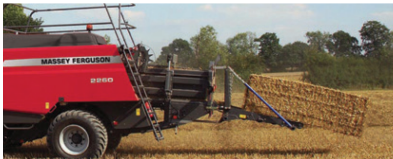
El sistema de pesaje de pacas integrado pesa la paca en el momento en que sale de la cámara.
