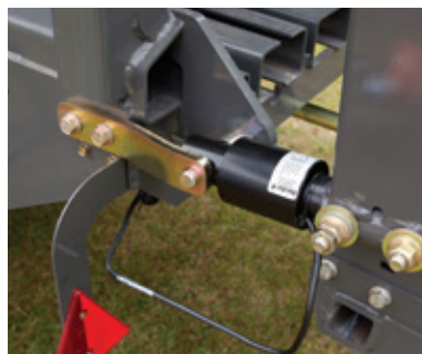
El sistema de pesaje de pacas integrado incorpora células de carga de alta precisión.
