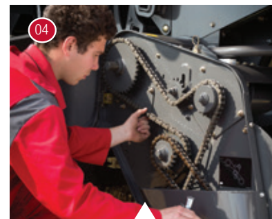
04 Comprobación de las tensiones de la cadena del pick-up.
