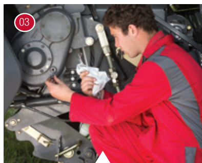
03 Comprobación del nivel de aceite de la caja de engranajes del picador.
