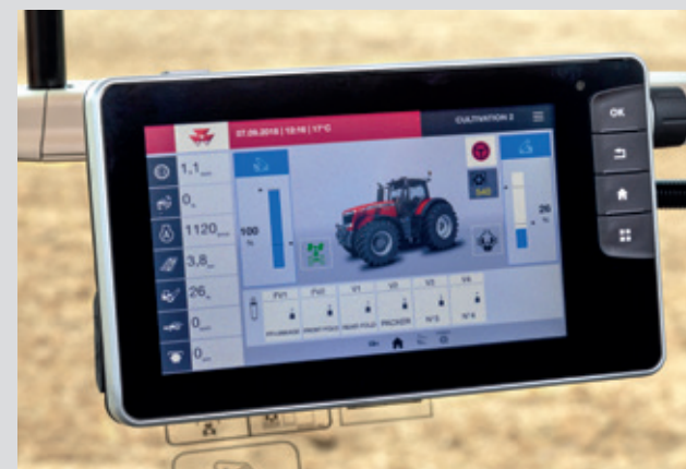
Control de la empacadora a través del terminal ISOBUS del tractor.
