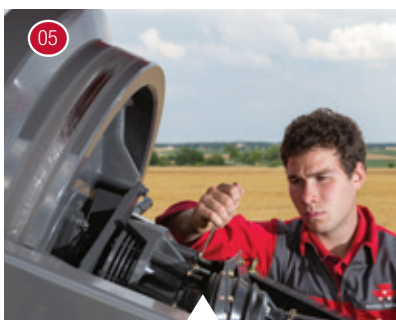
05 Ajuste del embrague deslizante del volante.
