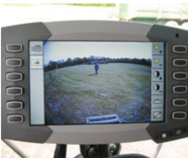
La empacadora cuenta con una preinstalación de cable para facilitar la instalación de una videocámara. El monitor C1000 de serie reproduce vídeo a todo color.
