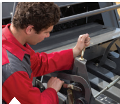
Ajuste de longitud de paca sencillo y fiable. La estrella nos da la longitud de la paca, montada en el centro de la cámara de pacas, sujeta con la puerta de la cámara superior, lo que garantiza que la estrella obtenga una tracción firme en todo tipo de cultivos para lograr una mayor precisión en la longitud de las pacas.
