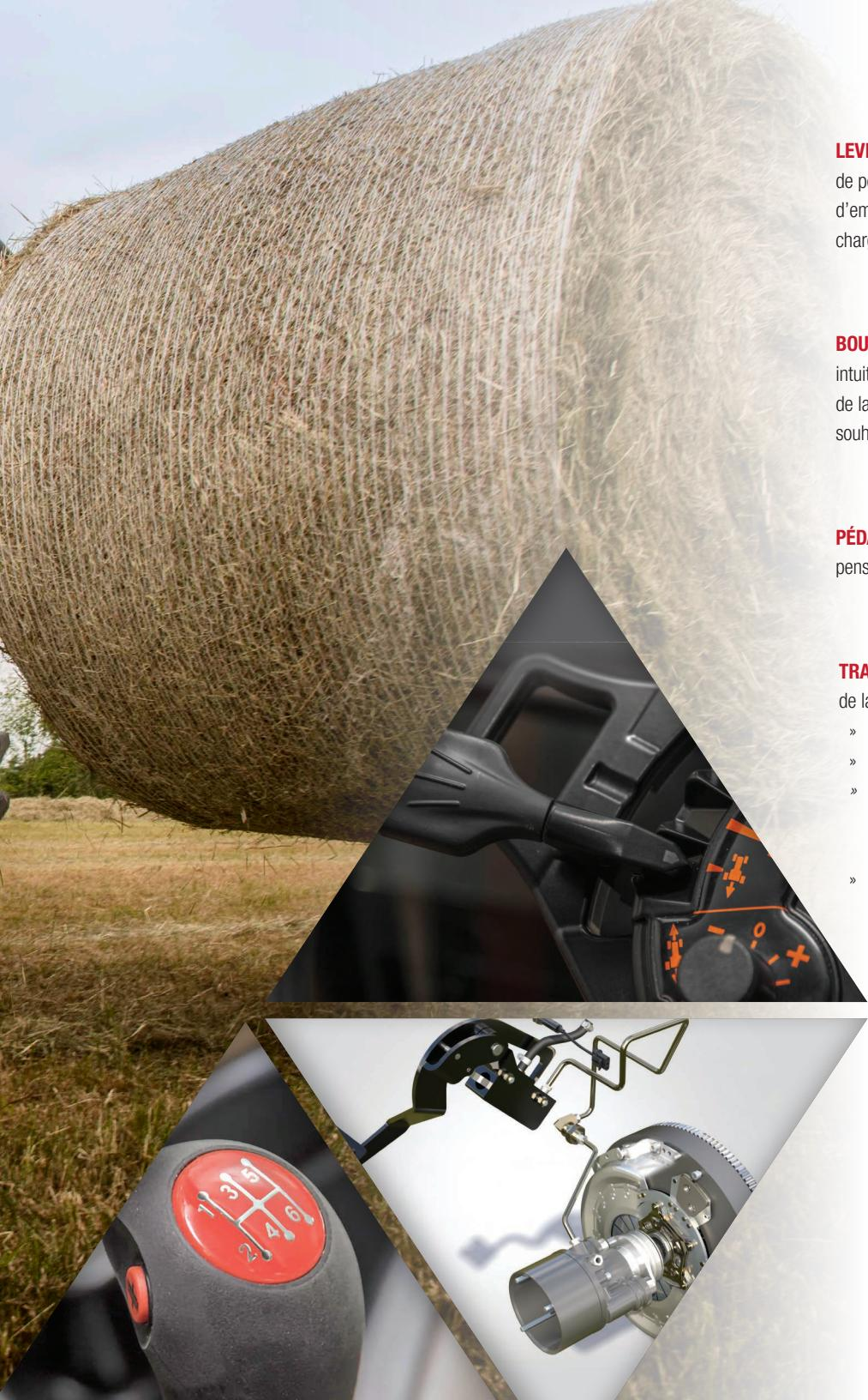
**LEVIER DE COMMANDE DE PUISSANCE** — Situé à gauche, il permet une utilisation simple et pratique de la transmission de pointe, trois en un. Les opérateurs peuvent passer de la marche avant à la marche arrière sans utiliser de pédale d'embrayage. Cela facilite les tâches nécessitant de fréquents changements de direction comme lors des travaux avec le chargeur. Le degré de réactivité de la navette peut être modifié en réglant simplement la molette du cadran *Comfort Control*.
