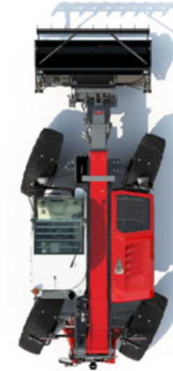
YENGEÇ DÜMENLEME modu - verimli bir doldurma ve tesviye çalışması ve dar alanlarda duvar yanında çalışma.
