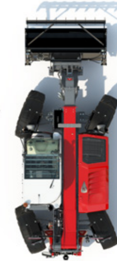
DÖRT TEKERLEKTEN dümenleme modu - minimum dönme daireleri için.
