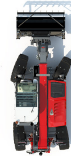
YARI-YENGEÇ DÜMENLEME modu, arka tekerlek açısını ayarlar - silaj veya ahır temizliği gibi uygulamalar için kullanışlıdır.
