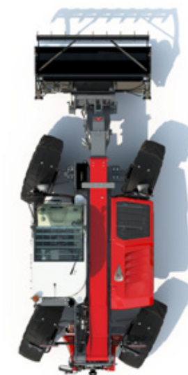
KRABBSTYRNING – för effektiv schaktning och återfyllning samt arbete längs väggar och i trånga utrymmen.
