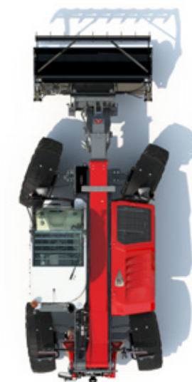
SEMIKRABBSTYRNING – låser den bakre hjulvinkeln i önskad position – användbar för tillämpningar som t.ex. packning av plansilo.
