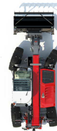
Mod de direcție SEMI CRAB – unghi roată spate setat – util pentru aplicații, precum însilozarea și curățarea șurei.
