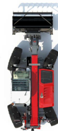
Mod de direcție CU PATRU ROȚI – pentru raze minime de bracare.
