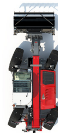
Mod de direcție CRAB – pentru o umplere și stivuire eficientă și pentru lucrări de-a lungul zidurilor și în spații restrânse.
