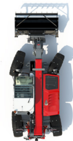
KRABBESTYRINGS-modus Med valgbar bakhjulsvinkel – nyttig for bruksområder som ensilasje og stallrensjøring.
