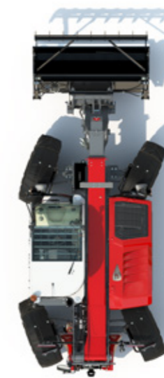
STUURMODUS VOOR vierwielbesturing – voor een minimale draaicirkel.
