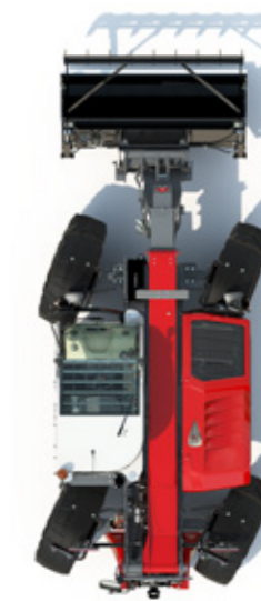
HONDENGANGmodus – voor efficiënt vullen en nivelleren en werken langs muren en in nauwe ruimten.
