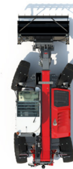
SEMI-HONDENGANGmodus vaste achterwielhoek – voor toepassingen zoals inkuilen of schuurreiniging.
