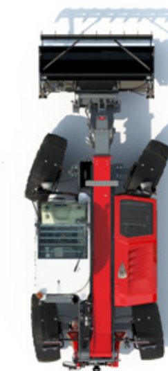
MODALITÀ A spostamento semi-laterale Impostazione dell'angolo delle ruote posteriori – utile per applicazioni come insilato o pulizia.
