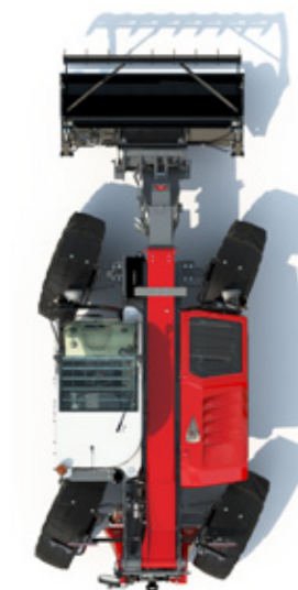
ΚΙΝΗΣΗ ΤΥΠΟΥ ΚΑΒΟΥΡΑ (CRAB-STEER) – για αποτελεσματικές επιχωματώσεις και διαμόρφωση κλίσης εδαφών, και εργασίες κατά μήκος τοίχων σε περιορισμένους χώρους.
