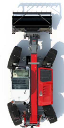
ΛΕΙΤΟΥΡΓΙΑ ΔΙΕΥΘΥΝΣΗΣ και στους τεσσέρις τροχούς – για τους μικρότερους κύκλους στροφής.
