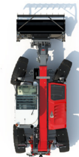
ΛΕΙΤΟΥΡΓΙΑ πλαγιοδρόμησης με ρυθμισμένη σταθερή γωνία πίσω τροχών – χρήσιμη για εφαρμογές όπως ενσίρωση ή καθαρισμός αχυρώνων.
