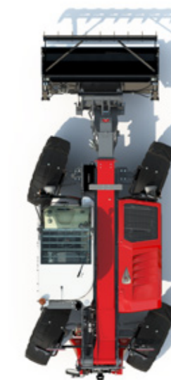
MODE MARCHÉ EN CRABE – pour les travaux le long des murs et dans les espaces confinés.
