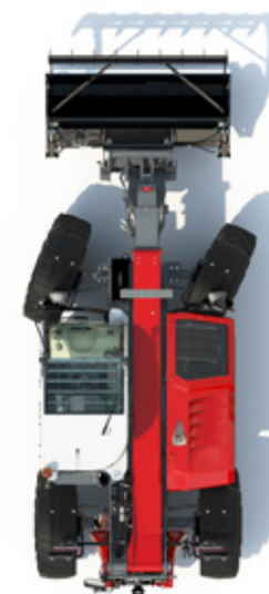
Vorderachslenkung – Der Modus für eine sichere Straßenfahrt
