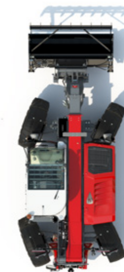
РЕЖИМ НА УПРАВЛЕНИЕ на четири колела – за минимални радиуси на завиване.
