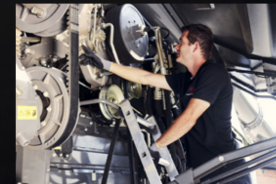
Transmisii simplificate cu puține curele și lanțuri
