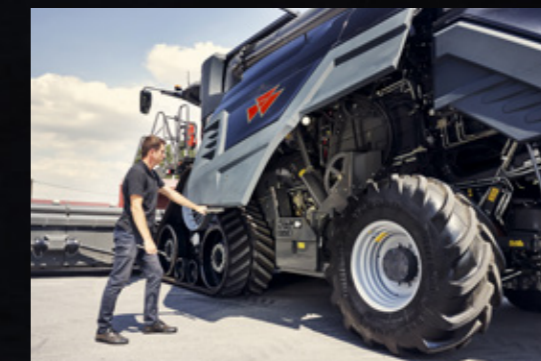
Panourile monobloc iluminate asigură un acces rapid și comod în vederea inspecției
