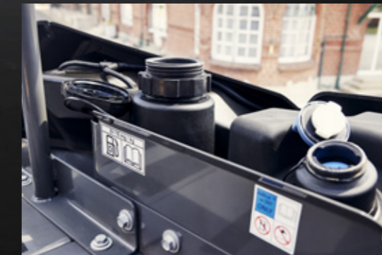
Realimentare ușoară – capacele rezervoarelor de carburant diesel și AdBlue sunt unul lângă celălalt, pentru un acces comod
