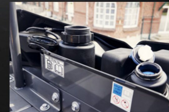
Enkel fylling: Diesel- og AdBlue-tanklokkene er plassert ved siden av hverandre for enkel tilgang
