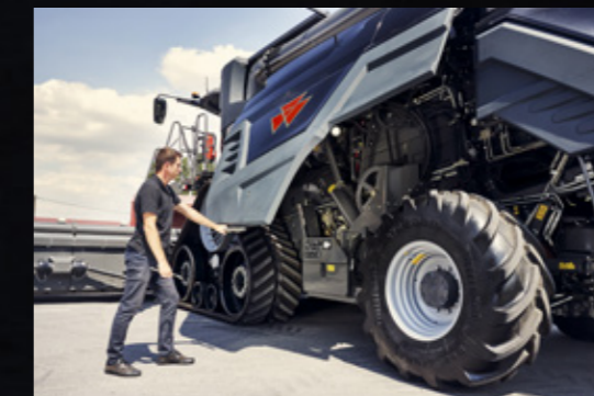
Les grands panneaux avec éclairage facilitent l'accès pour les contrôles
