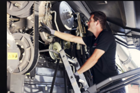
Yksinkertaistettu voimansiirto, jossa on vähän hihnoja ja ketjuja
