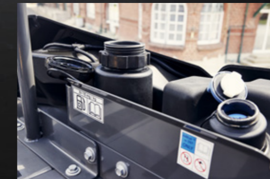
Лесно зареждане с гориво – резервоарите за дизел и AdBlue се намират един до друг за удобен достъп
