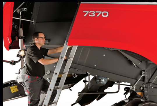
Çıkarılabilir merdivenle güvenli motor bölümü ve dane deposu erişimi
