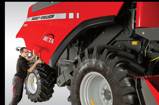
Hızlı bir servis erişimi sağlayan, aydınlatmalı tek parça yan kapaklar
