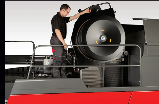
Radyatör temizliği için güvenli ve kolay erişim
